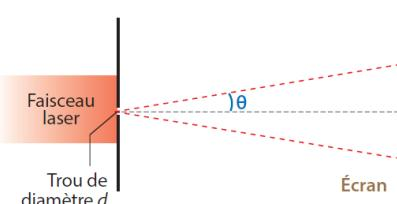
On obtient des anneaux de diffraction avec une tache centrale nettement plus lumineuse que les autres.
