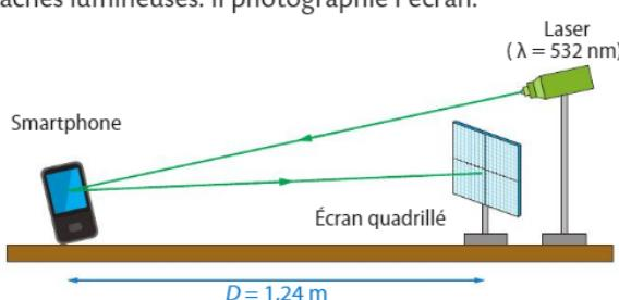
Un écran de téléphone portable est constitué de pixels (points lumineux). Un phénomène de diffraction se produit lorsque le faisceau laser rencontre un obstacle suffisamment petit, le pixel, de taille  $a$ . Un pixel joue le même rôle qu'une ouverture de même taille lors de la diffraction.
